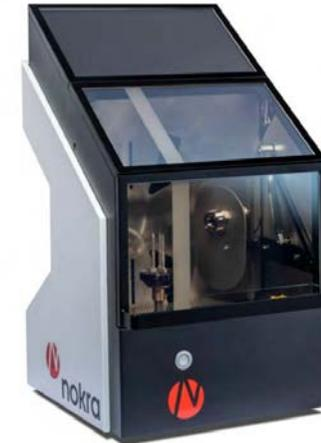
Die neue Heißmesszelle misst die vollständige Kontur von warmen Schmiedeteilen und berechnet die Abmessungen der Teile im erkalteten Zustand.
